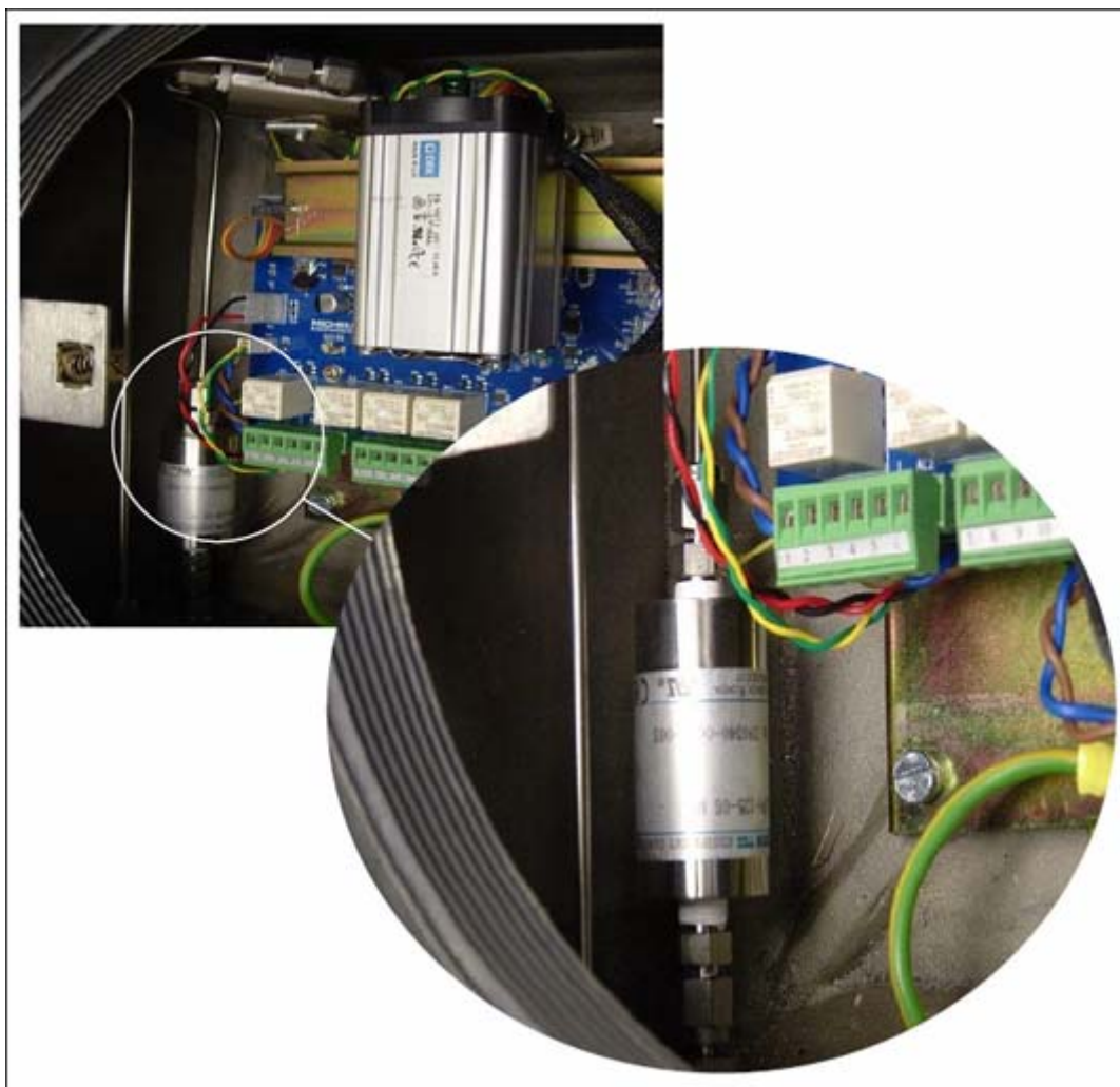
Рис. 10. Расположение реле расхода газа.
